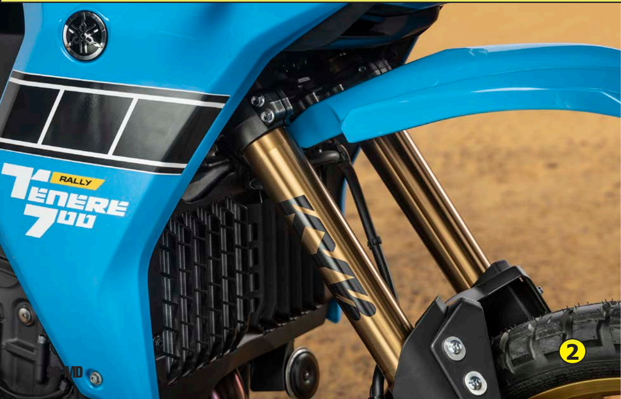
• 1) Con su estampa de moto de Rally, la Ténéré es un ícono de la marca de los tres diapasones . • 2) La horquilla delantera es una Kayaba con barras de 43 mm y 210 mm de extensión. • 3) Nueva pantalla TFT de 6,3"
