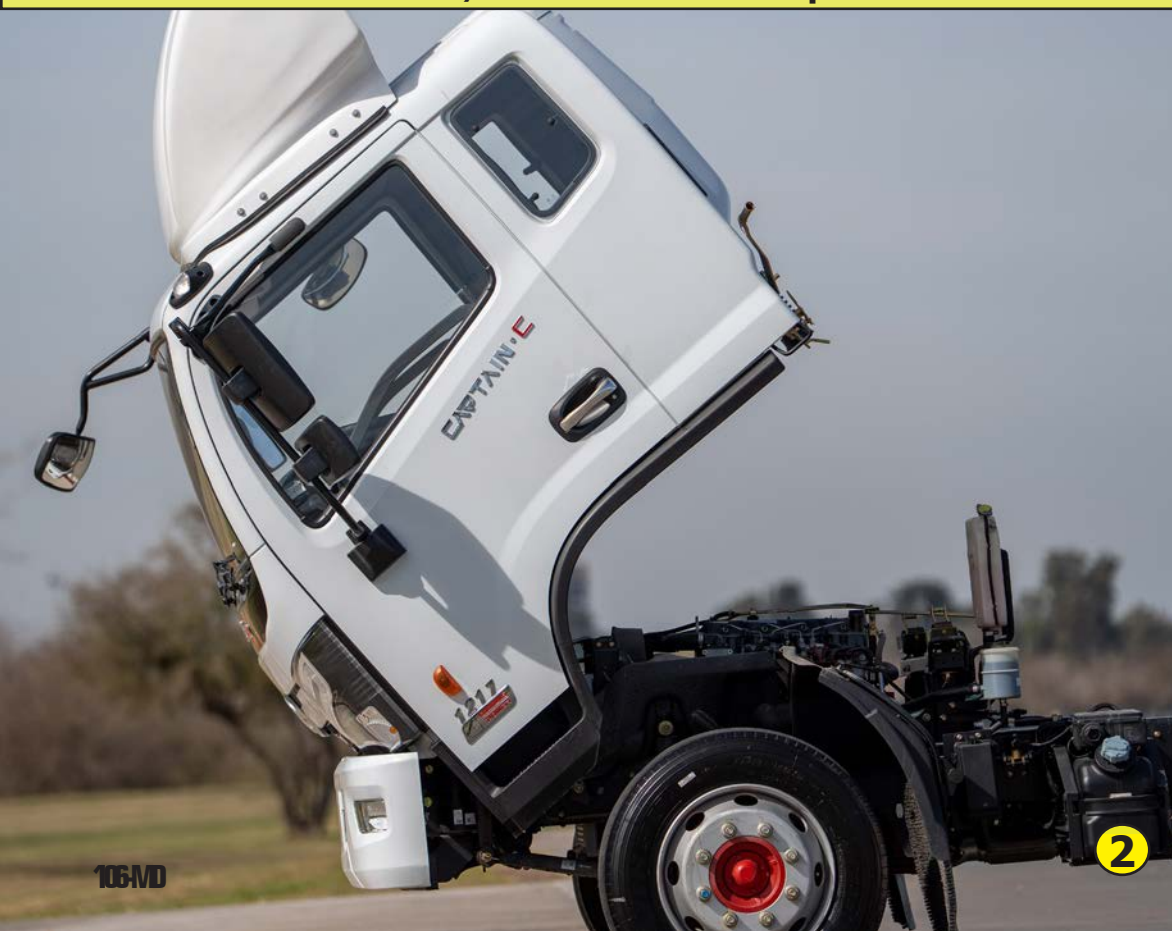
• 1) Interior del Dongfeng Captain W con pantalla multimedia y cámara de retroceso. • 2) Como es clásico en los camiones frontales, la cabina del Captain C se rebate . • 3) El Captain W ofrece caja con laterales rebatibles
