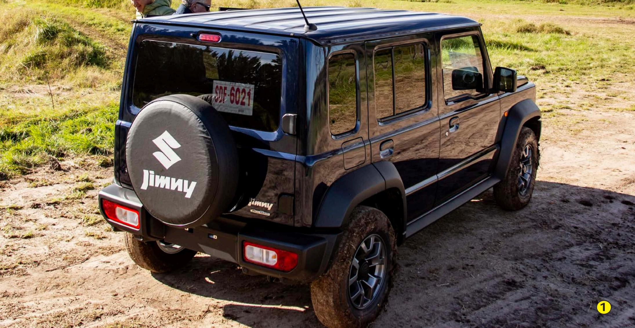
• 1) El diseño trasero es el más clásico de los vehículos 4x4, con la rueda de auxilio en el portón. • 2) Además del volante multifunción, el toque moderno lo da la pantalla táctil de 9". • 3) El despeje del suelo es de 210 mm
