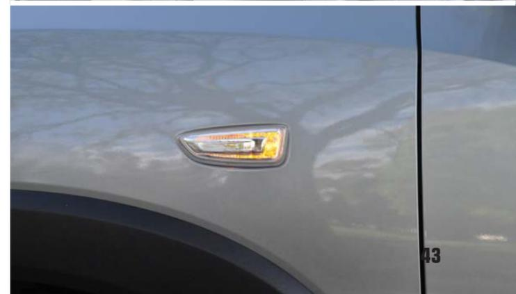
• El diseño exterior, con el capot más alto, nuevos paragolpes, parrilla y ópticas lo asimilan a la estética de los B-SUV. • Los espejos exteriores tienen regulación eléctrica, pero no luz de giro, que se ubica en el guardabarro
