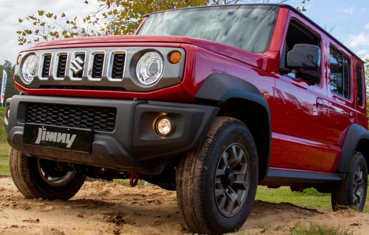
padas o descensos. Así, este Jimny de 5 puertas ofrece un ángulo de ataque o entrada de 37°; de salida de 49° y de rampa o ventral de 28°. Suma un gran despeje de 210 mm.
