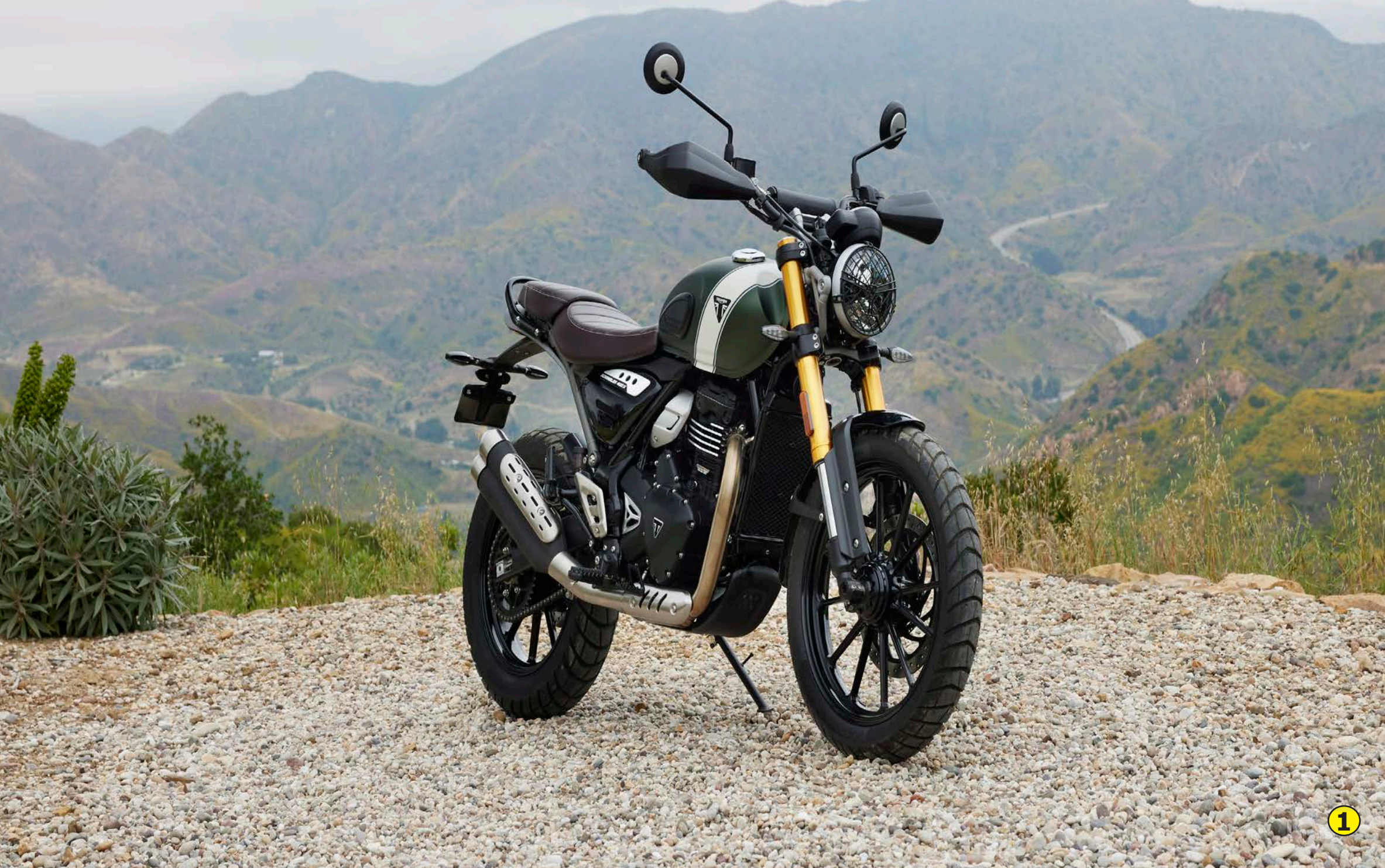
•1)La Triumph Scrambler 400 X tiene motor monocilíndrico 4T con 4 válvulas que entrega 40 CV a 8000 rpm y 37,5 Nm de torque a 6500 rpm. •2)Tablero analógico-digital. •3)Tanque, manillar y horquilla de la Speed
