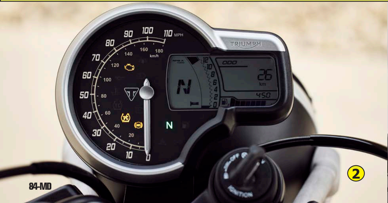
•1)La Triumph Scrambler 400 X tiene motor monocilíndrico 4T con 4 válvulas que entrega 40 CV a 8000 rpm y 37,5 Nm de torque a 6500 rpm. •2)Tablero analógico-digital. •3)Tanque, manillar y horquilla de la Speed
