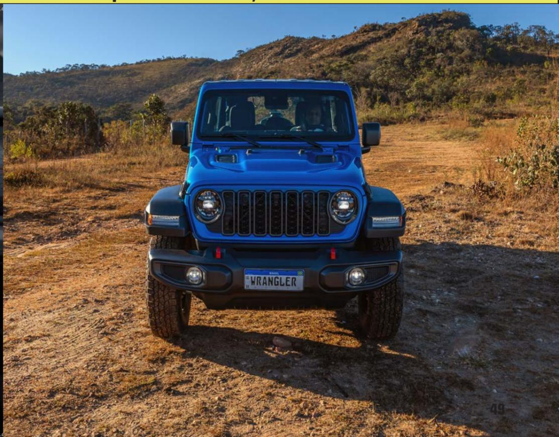
• El nuevo Jeep Wrangler Unlimited Rubicon tiene ahora el motor turbonaftero Hurricane 4 en línea 2.0 L que entrega 270 CV a 5250 rpm y un par de 400 Nm a 3000 rpm. • La transmisión es automática (del tipo convertidor de par) de 8 velocidades. • Cuenta con el sistema de tracción Rock-Trac HD Full Time 4WD
