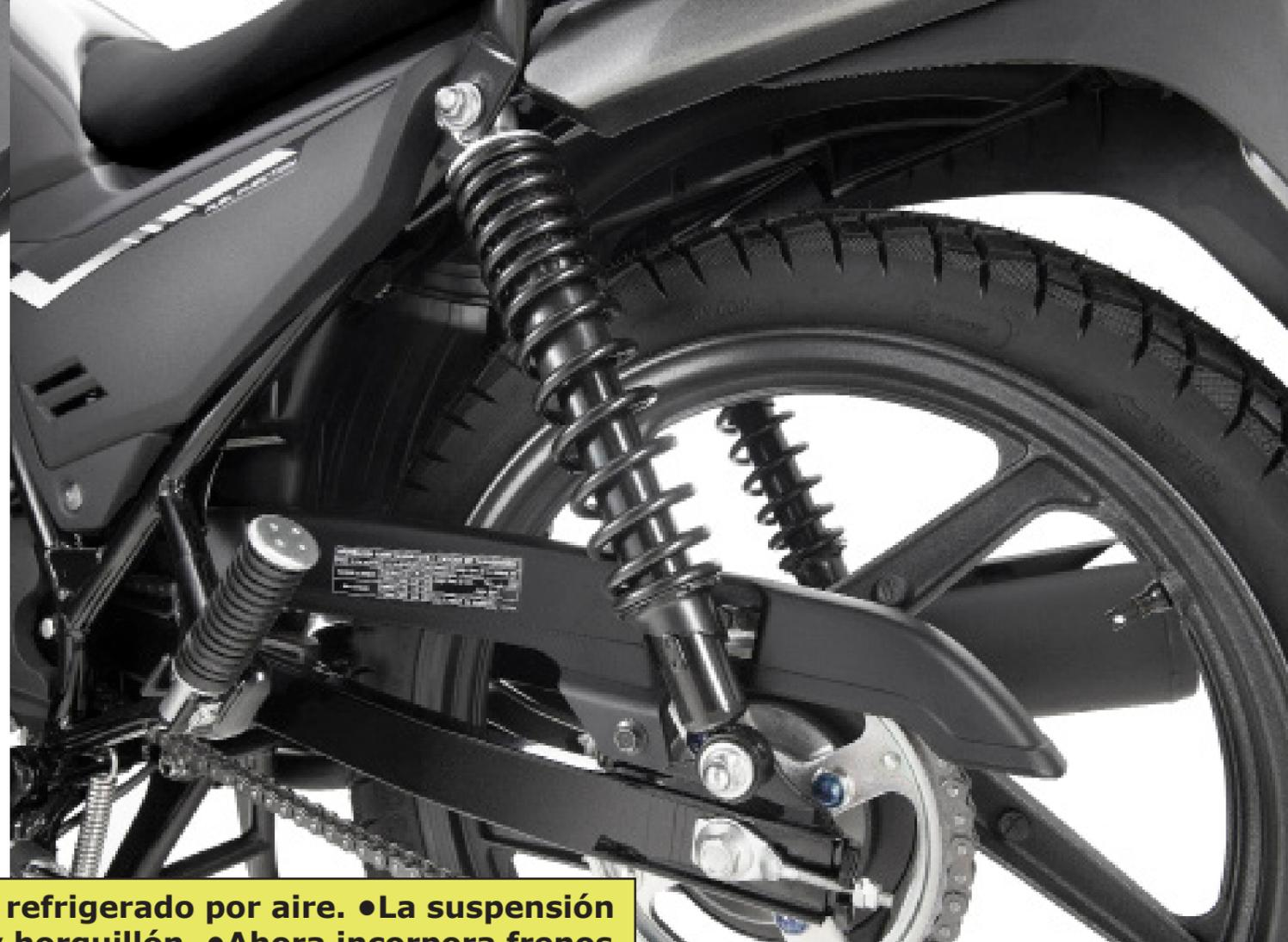
●Motor monocilíndrico 4T de 149 cc refrigerado por aire. ●La suspensión trasera es por doble amortiguador y horquilla. ●Ahora incorpora frenos CBS (*Combined Braking System*) que equilibra la fuerza de frenado
