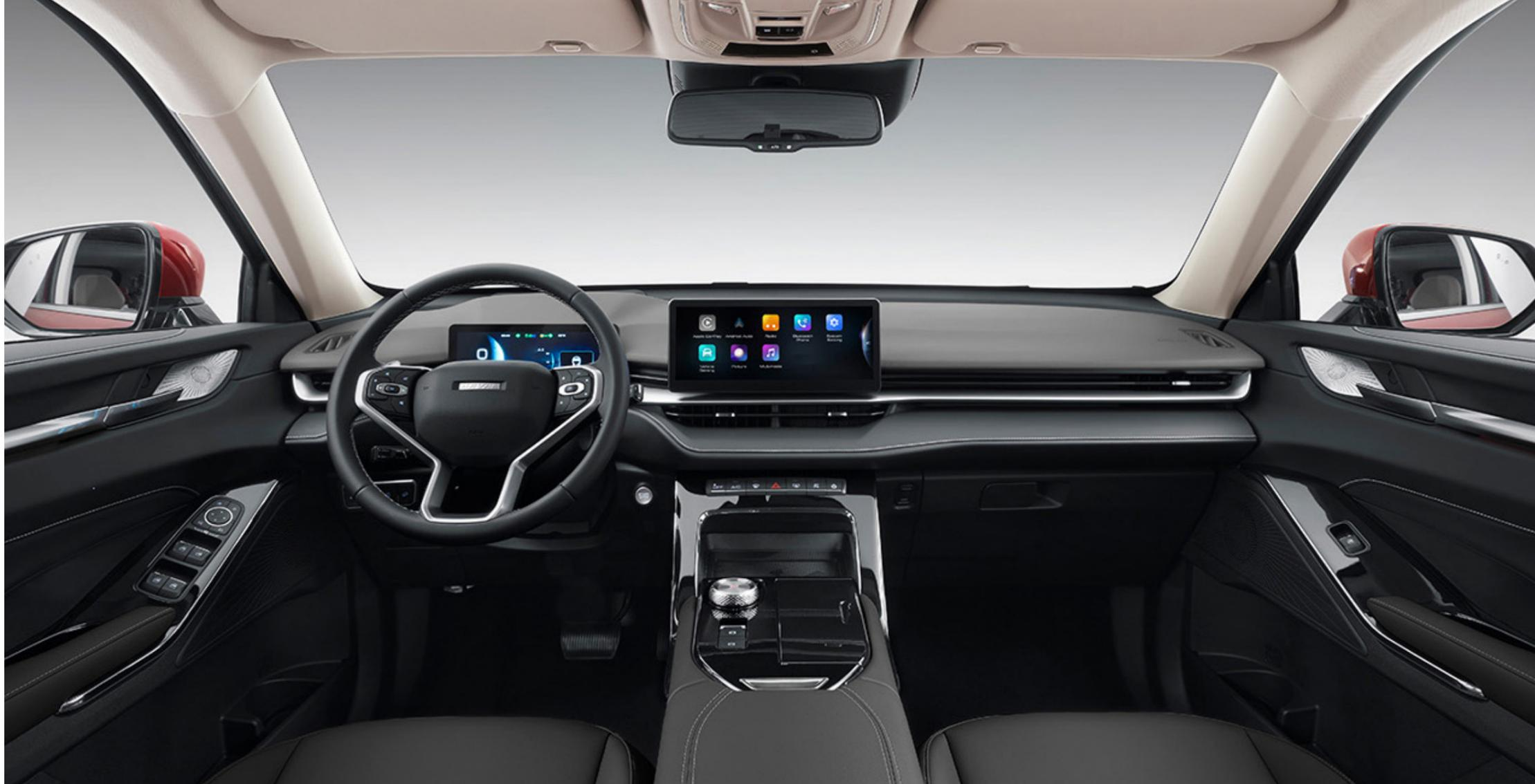
●El panel de instrumentos es directamente una pantalla táctil de 10,25". ●La central multitáctil es de 12,3" e incluye Apple CarPlay y Android Auto. ●La selectora fue reemplazada por un dial. ●Butacas con ajuste eléctrico
