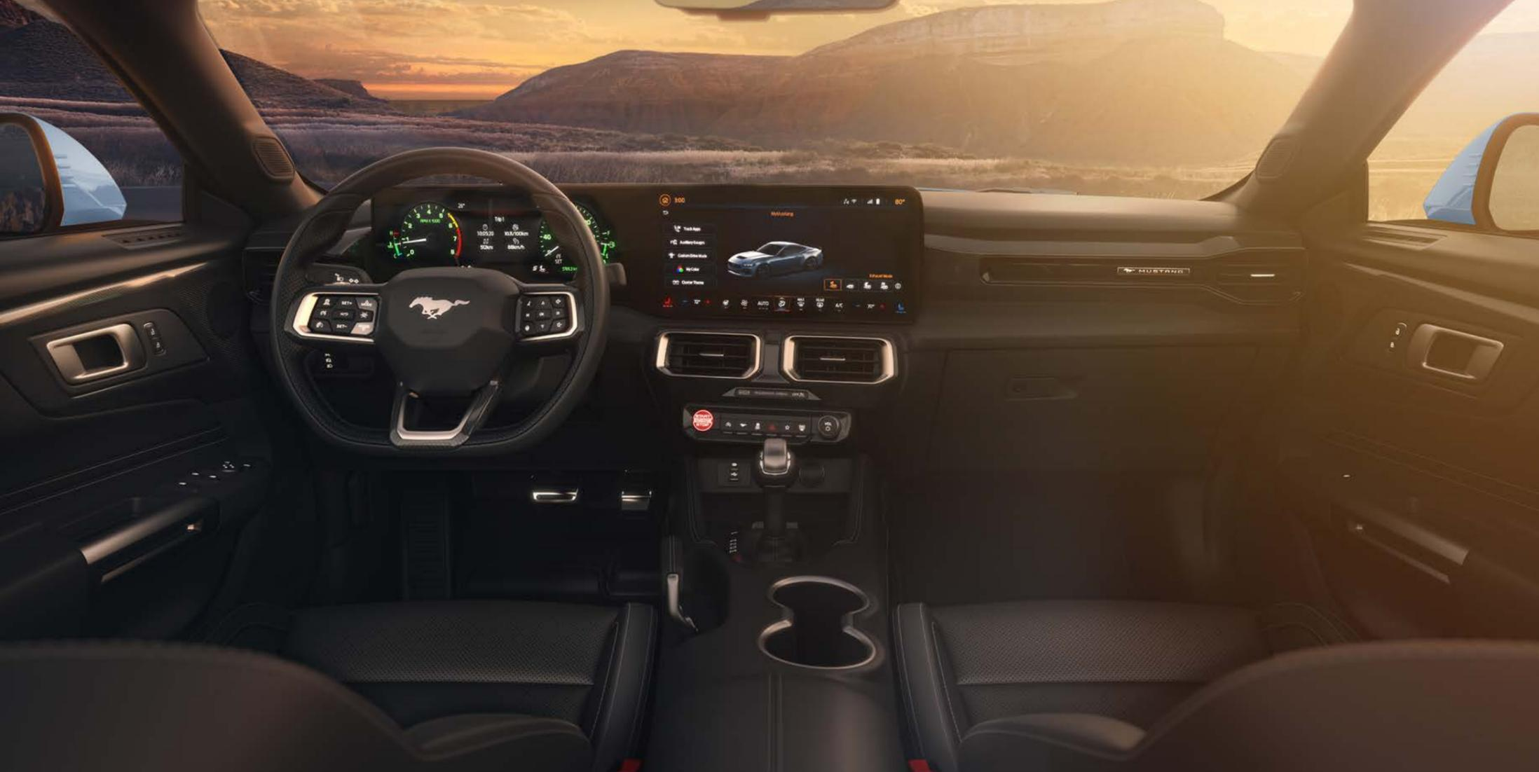
•El interior ofrece un panel de instrumentos digital configurable de 12,4". •Incluye el sistema multimedia SYNC 4 con pantalla de 13,2". •Las butacas de cuero microperforado tiene calefacción y refrigeración
