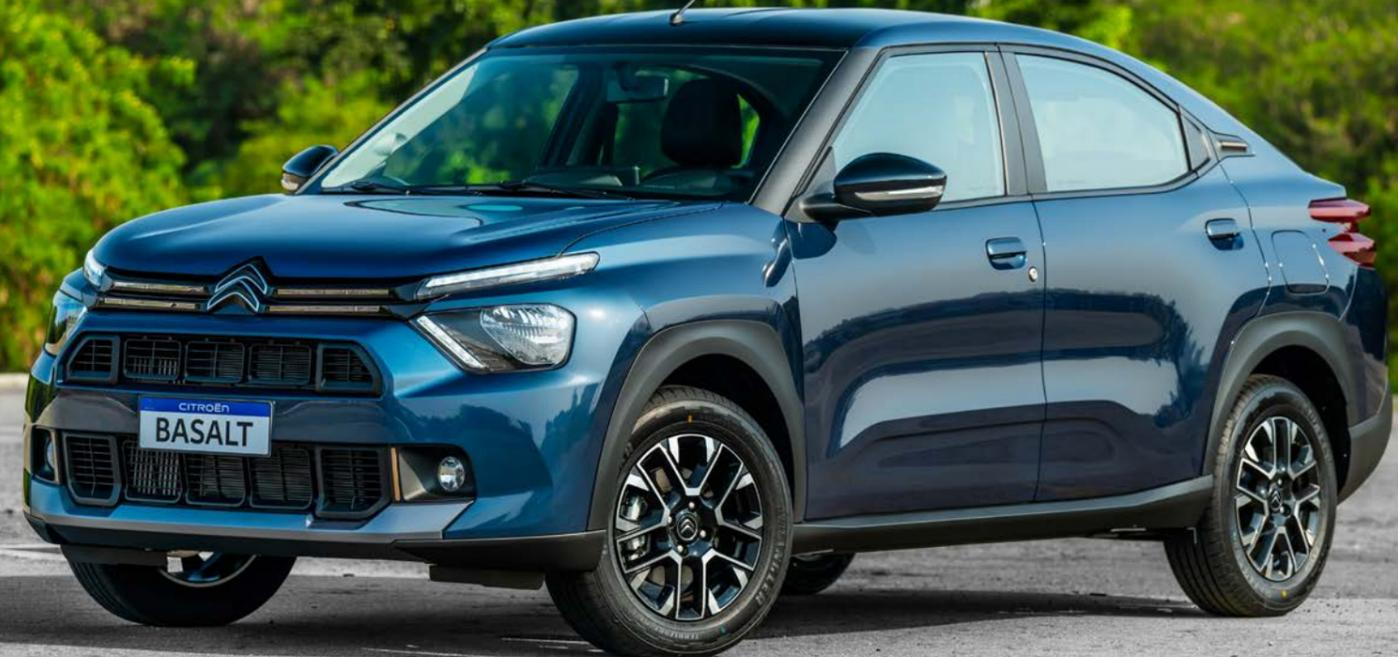
• El Basalt fue diseñado para la región en Brasil, donde se lo fabrica. • La carrocería de este B-SUV tiene un estilo fastback. • Tiene una distancia entre ejes de 2,64 metros que favorece sus proporciones. • La versión Shine cuenta con el motor turbonaftero tricilíndrico T200 1.0 L de 120 CV y 200 Nm
