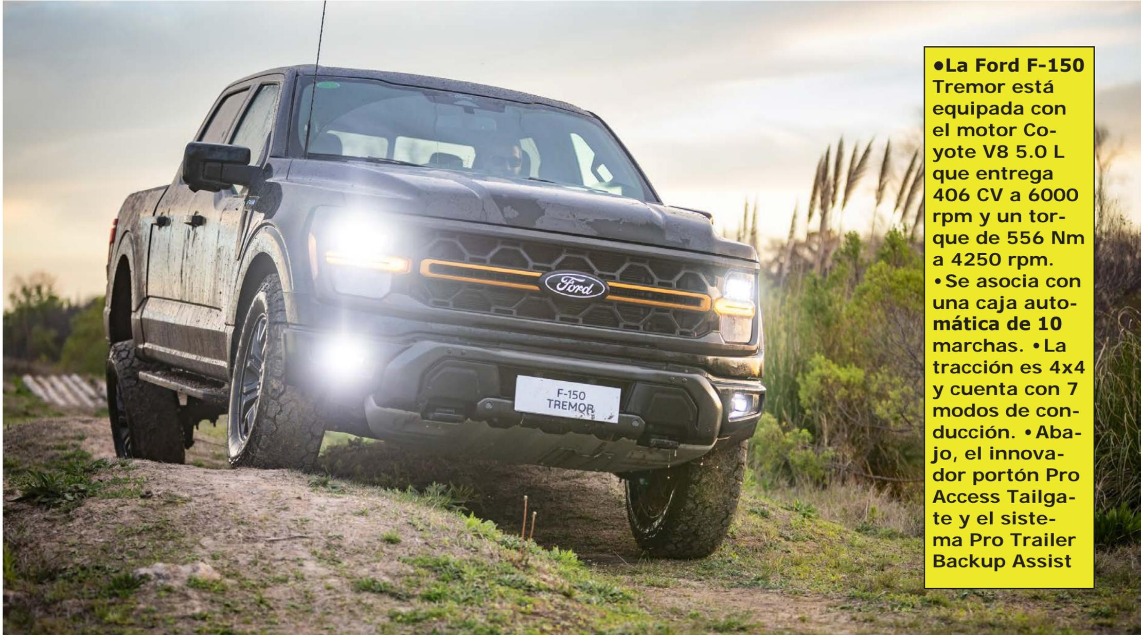
• La Ford F-150 Tremor está equipada con el motor Coyote V8 5.0 L que entrega 406 CV a 6000 rpm y un torque de 556 Nm a 4250 rpm. • Se asocia con una caja automática de 10 marchas. • La tracción es 4x4 y cuenta con 7 modos de conducción. • Abajo, el innovador portón Pro Access Tailgate y el sistema Pro Trailer Backup Assist
