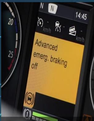
El Sistema inicia frenada de emergencia si el conductor no reacciona a tiempo
