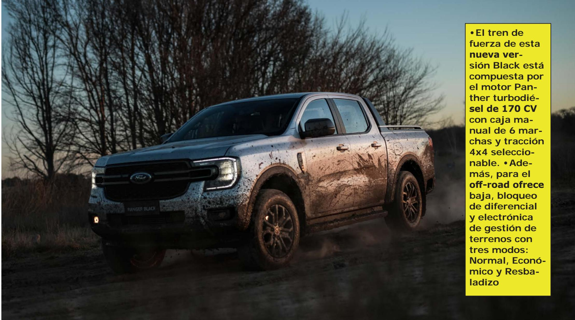
• El tren de fuerza de esta nueva versión Black está compuesta por el motor Panther turbodiésel de 170 CV con caja manual de 6 marchas y tracción 4x4 seleccionable. • Además, para el off-road ofrece baja, bloqueo de diferencial y electrónica de gestión de terrenos con tres modos: Normal, Económico y Resbaladizo
