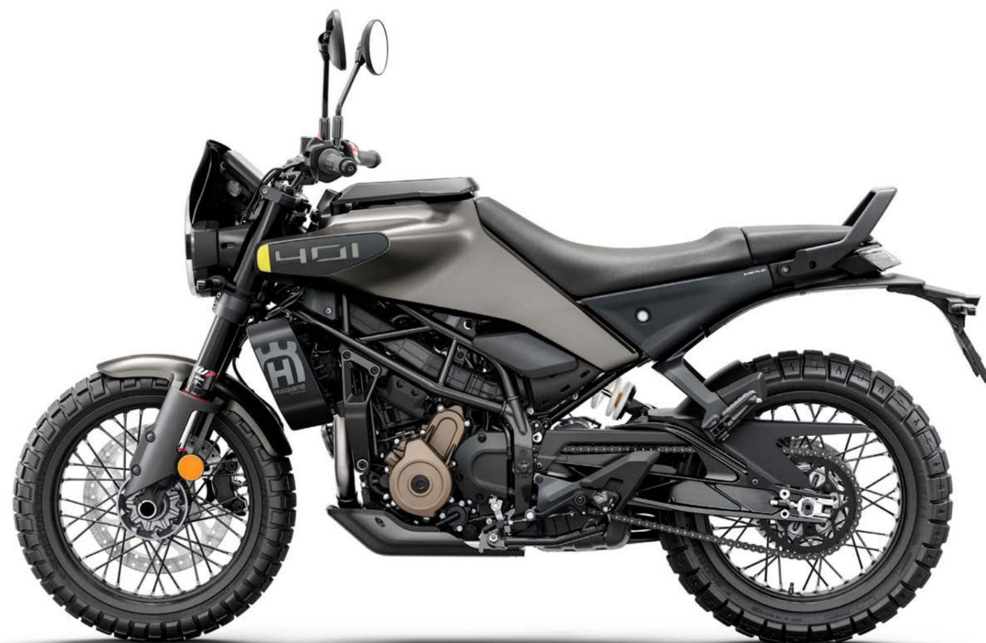
●La Svartpilen 250 (izq.) cuenta con un monocilíndrico 4T de 31 CV y 25 Nm. ●El mono de la 401 (der.) pasó de 373 cc a 399 cc. ●Diseño minimalista y neoclásico para estas naked ensambladas en el país
