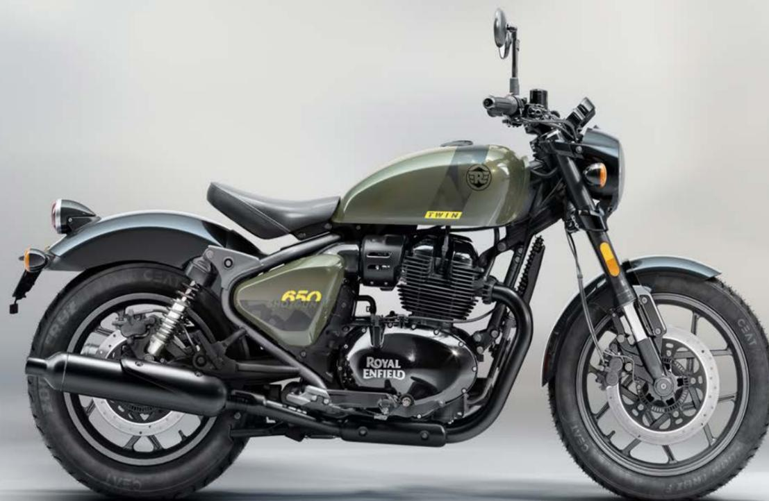
constante y un amplio control a todas las velocidades, ya sea que el piloto viaje solo o con peso adicional. Este modelo utiliza llantas de aleación con neumáticos tipo tubeless, 100/90 R18 delante; y 150/70 R17 detrás.
