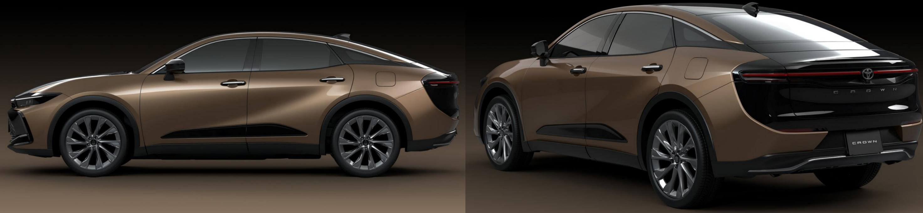
•Con un diseño exterior disruptivo, tiene 4980 mm de longitud por 1840 mm de ancho y 1555 mm de alto. •La imponente carrocería hacen parecer pequeñas las ruedas con llantas de 21". •La suspensión trasera es mediante sistema Multilink, lo que aporta al excelente confort de marcha del Crown
