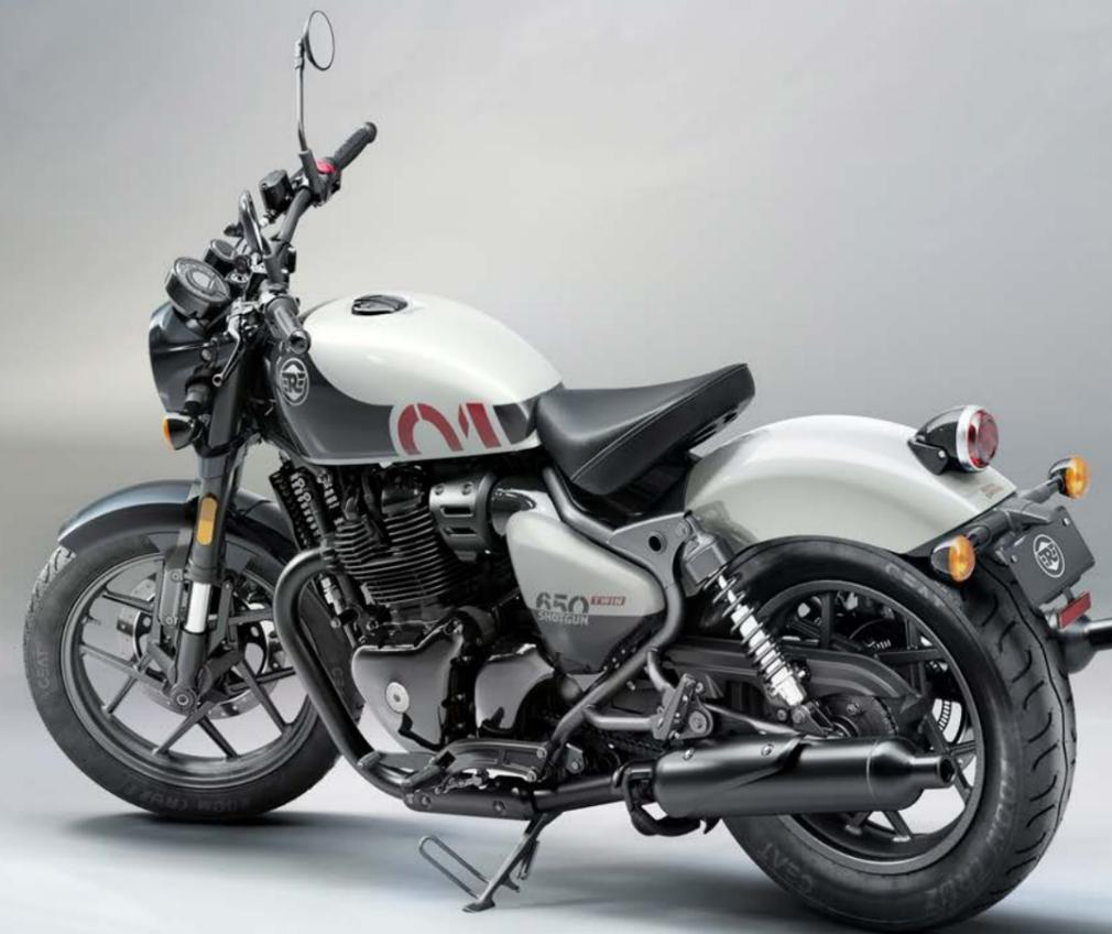
•Horquilla delantera invertida Showa "Big Piston" con barrales de 43 mm. •Suspensión trasera de dos amortiguadores con ajuste de precarga. •La altura del asiento es de 795 mm. •Frenos Brembo con ABS
