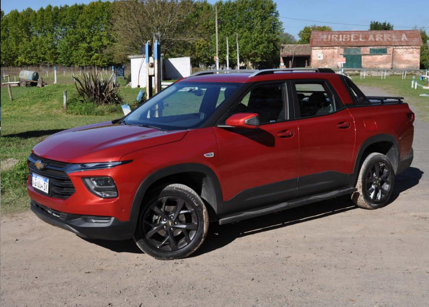
**La Montana dispone de una larga distancia entre ejes, que la hace muy estable en la ruta y permitió el diseño de una caja de carga amplia y funcional; el motor tricilíndrico turbonaftero de 1.2 L le cae de maravillas y ofrece un muy buen rendimiento junto con la caja automática de 6 marchas**
