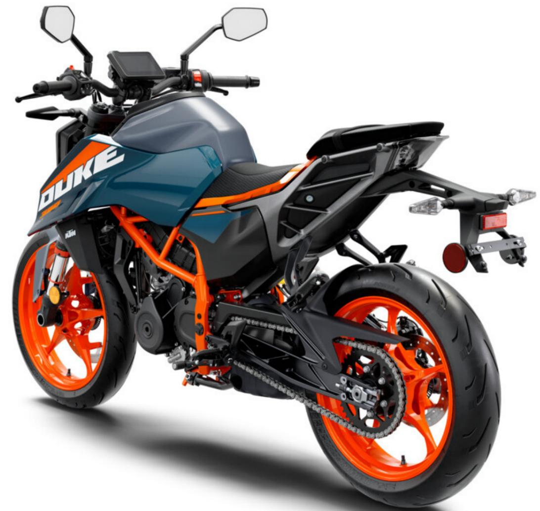
ciona una plataforma robusta y duradera para el sistema de suspensión trasera, que incorpora un soporte directo para el amortiguador desplazado hacia un lado, para conseguir ese aspecto más deportivo y una mayor eficacia dinámica.
