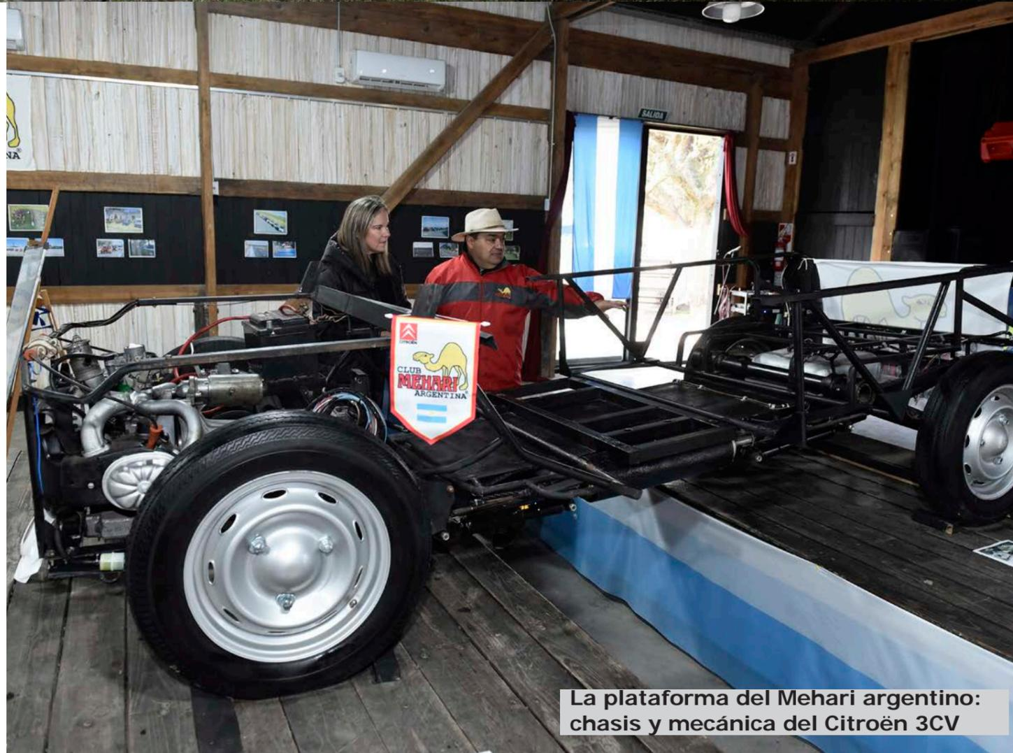
La plataforma del Mehari argentino: chasis y mecánica del Citroën 3CV
