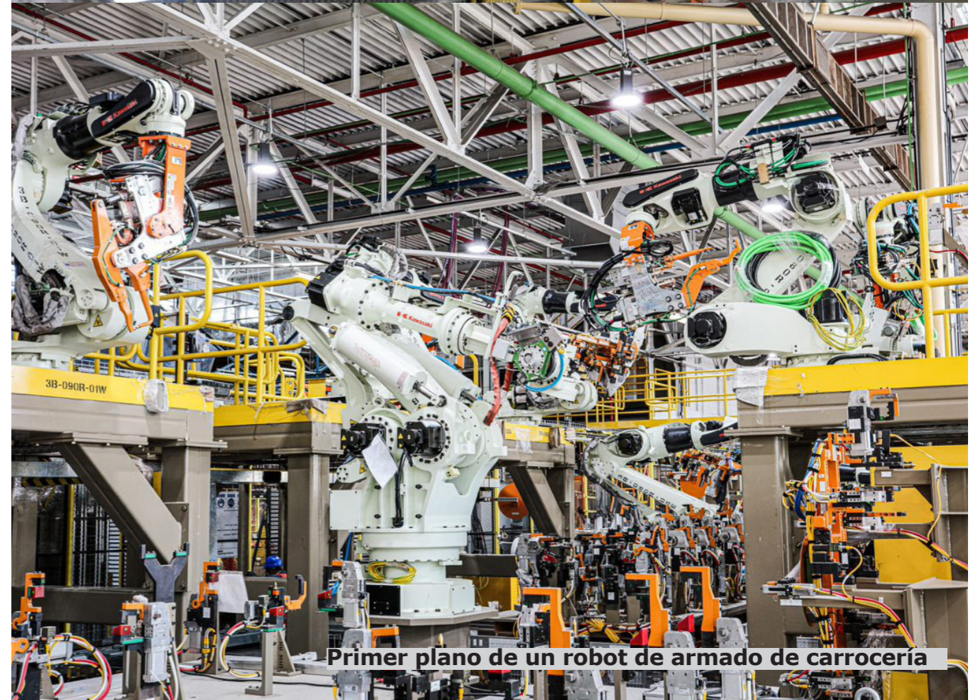
Las soldaduras son de extrema calidad y precisión
