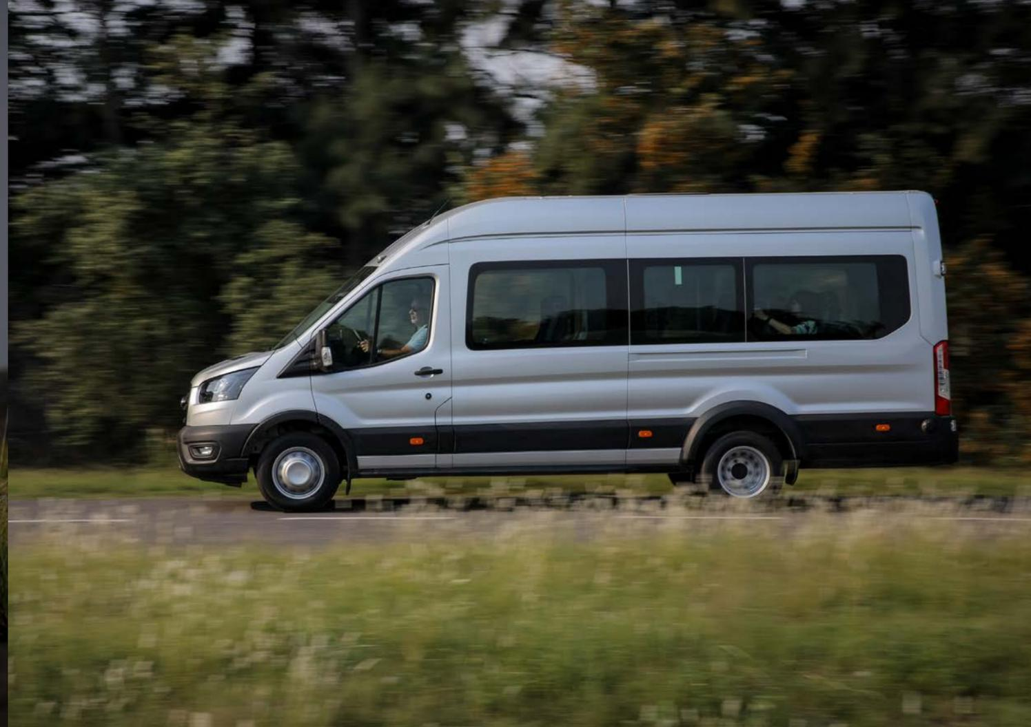
**El nuevo furgón Ford Transit L3H3, igual que los Minibus, cuenta con el motor Panther de 165 CV de potencia y 390 Nm de par; tiene un volumen de 12,4 m3**
