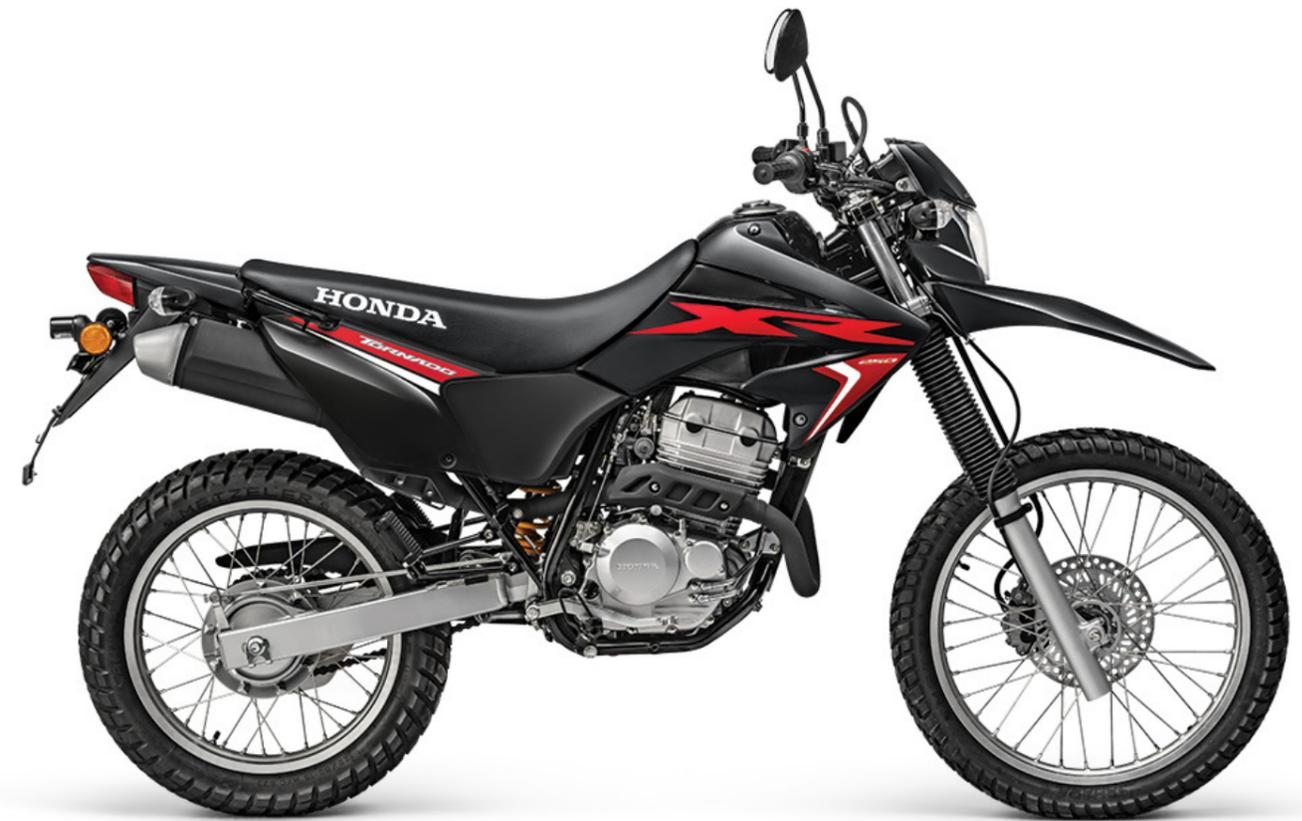
y un par de 23,73 Nm a 6000 rpm. La alimentación es mediante carburador de 32 mm de diámetro y cuenta con la transmisión Perfect Sync de 6 velocidades. El arranque es eléctrico.
