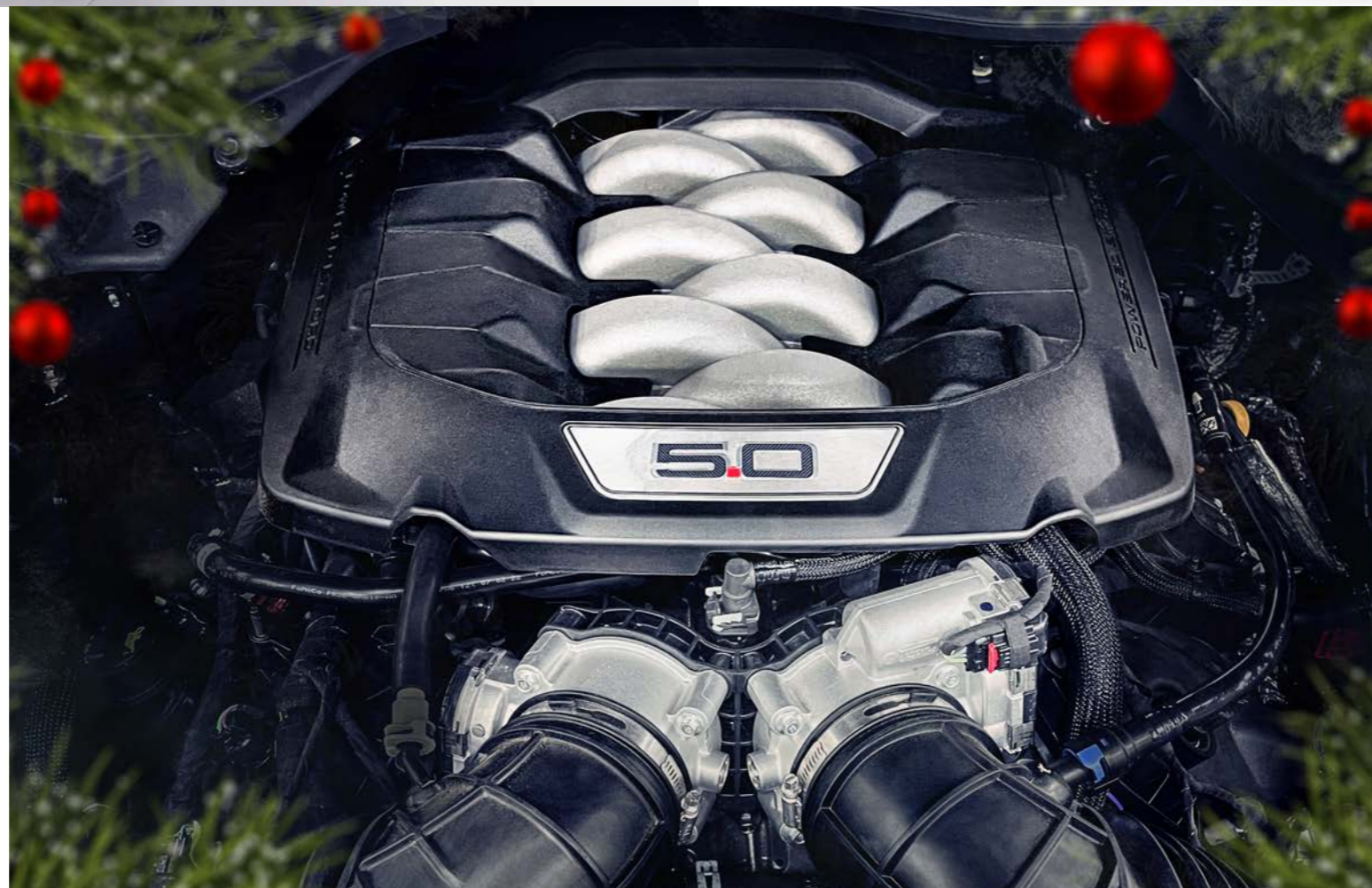
El impresionante propulsor Horsepower V8 5.0 L del Ford Mustang Dark Horse de reciente lanzamiento. Con sus 500 HP, entrega una potencia específica (la relación entre la potencia nominal y la cilindrada) de 100 CV/L, que paradójicamente es menor que el de pequeños motores turbo de 1.0 L o 1.2 L
