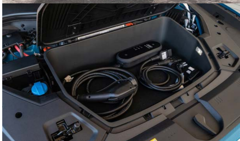
Bajo el capot se encuentra este baúl para guardar los cables y el adaptador para cargarlo en la red domiciliaria
