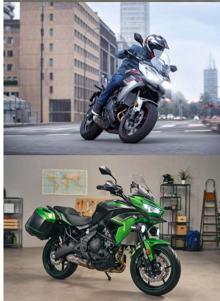
Los frenos están confiados a un par de discos lobulados semiflotantes de 300 mm de diámetro con pinzas de doble pistón adelante y un disco lobulado de 250 mm con caliper de un solo pistón, en la rueda trasera. Esta calza neumático 160/60 ZR17, mientras que el delantero es de rodado 120/70 ZR17.
